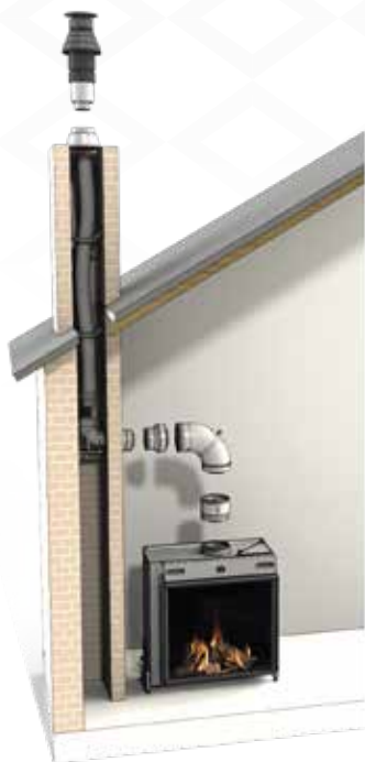
Via dak • flexibele pijp in schoorsteen
