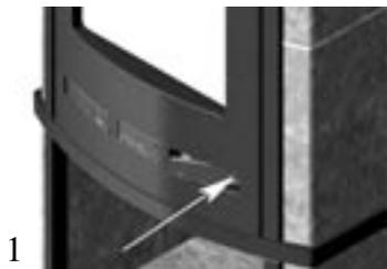
1. Entfernen Sie die überflüssigen (nicht alle!) Aschereste. Denken Sie daran, dass sich noch bis zu 24 Stunden nach dem Löschen des Feuers heiße Glut im Ofen befinden kann. Entleeren Sie den Verbrennungsraum immer in einen feuerfesten Behälter. Stellen Sie eine maximale Luftzufuhr sicher, indem Sie das Luftventil öffnen. Siehe auch Abbildung B.
