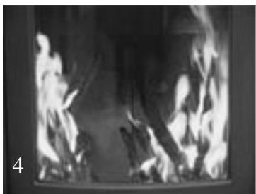
4. Sie können die Tür schließen, sobald das Feuer gut brennt. Schließen Sie gleichzeitig auch das bis dahin offene Rost. Lassen Sie den Ofen vollständig ausbrennen und abkühlen. Wiederholen Sie diesen Vorgang insgesamt zehn Mal. Entfernen Sie zwischen den einzelnen Einfuehrungsvorgängen nur die überschüssige Asche aus dem Verbrennungsraum.
