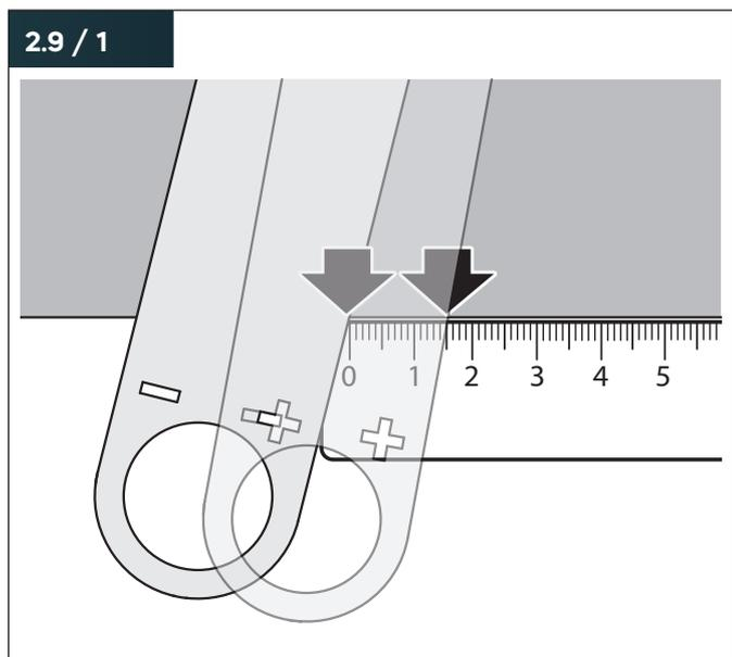
Ein an der Außenkante der Verkleidung bündig angesetztes Lineal ermöglicht es, die NWL-Stellung des Geräts zu bestimmen.
