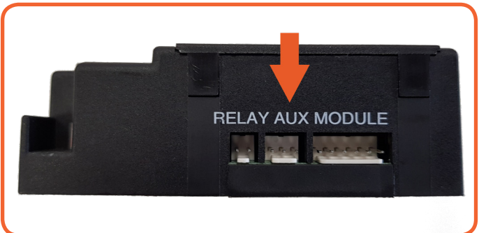
Afbeelding A.11- Aux-positie ontvanger
