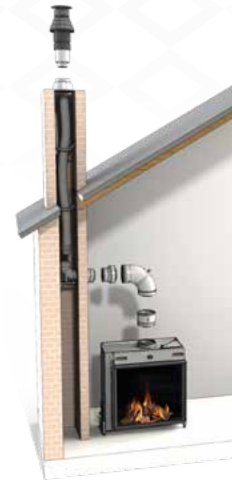
Via dak • flexibele pijp in schoorsteen
