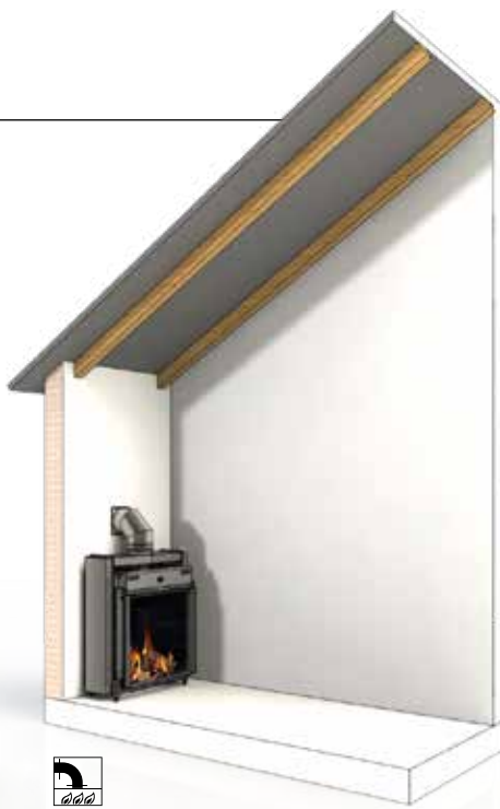
Via gevel • direct op de haard met een 90° bocht naar buiten • mogelijk op een groot deel van het assortiment
