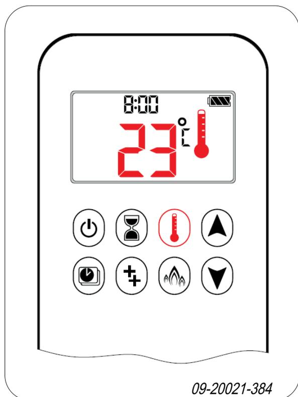
**AAN:** Druk op de [thermostaat] knop. Het symbool wordt weergegeven, de vooraf ingestelde temperatuur wordt kort weergegeven, en vervolgens de kamertemperatuur
