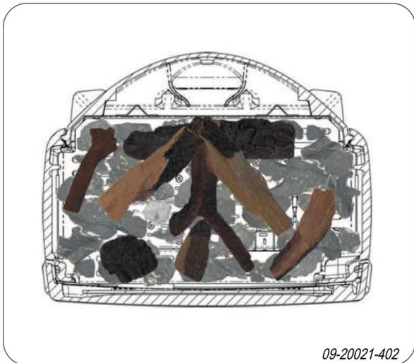
**i** La manière dont les cendres sont dispersées sur la surface du brûleur détermine l'aspect des flammes. Il est parfois nécessaire de modifier la répartition des cendres en dégageant partiellement quelques trous du brûleur pour obtenir une meilleure répartition des flammes.
