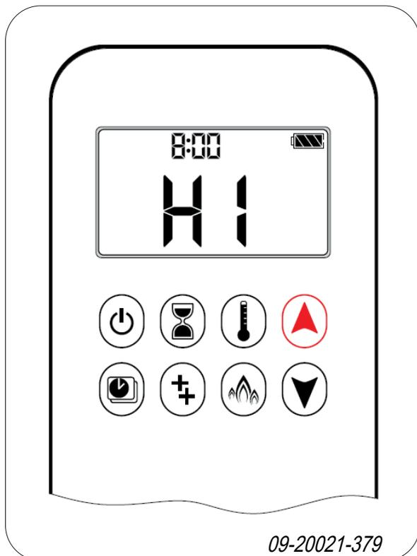
Doppelklicken Sie auf ▲, um zur hohen Flamme zu wechseln. Auf dem Display wird **HI** angezeigt.
