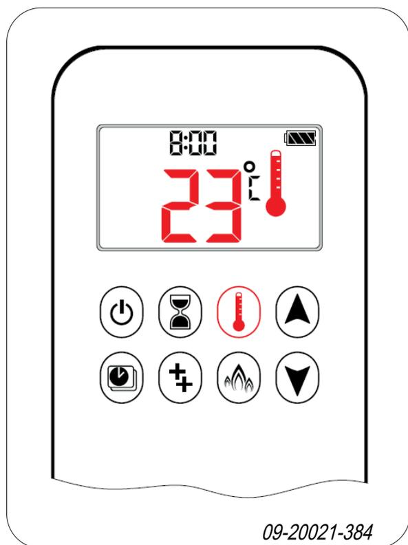
**ACTIVACIÓN:** Pulse el botón [termostato]. Aparecerá el símbolo, se mostrará brevemente la temperatura ajustada y, a continuación, la temperatura ambiente.
