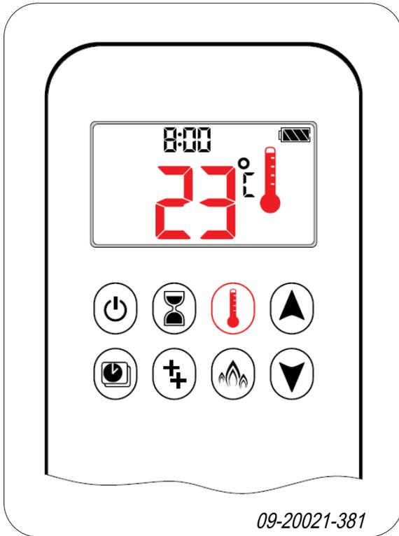
Se medirá la temperatura ambiente, comparándose con la temperatura configurada. La altura de la llama se adaptará automáticamente para alcanzar la temperatura configurada.
