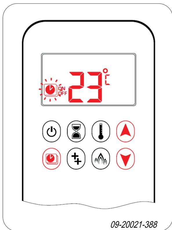
1. Halten Sie die Taste **[Programm]** gedrückt, bis das Symbol blinkt. „ON“ und die „EIN“-Temperatur werden angezeigt.
