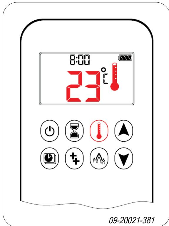
Die Raumtemperatur wird gemessen und mit der eingestellten Temperatur verglichen. Die Flammenhöhe wird dann automatisch angepasst, damit die eingestellte Temperatur erreicht wird.
