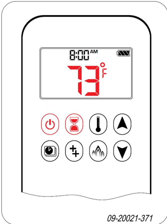
Drücken Sie zum Wechseln zwischen °C und °F gleichzeitig auf **[Ein/Aus]** und **[Timer]**.
