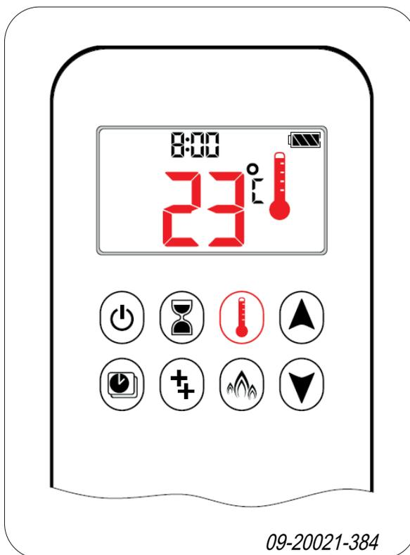
**EIN:** Drücken Sie auf die Taste **[Thermostat]**. Das Symbol wird angezeigt, die vorab eingestellte Temperatur wird kurz angezeigt, gefolgt von der Zimmertemperatur.
