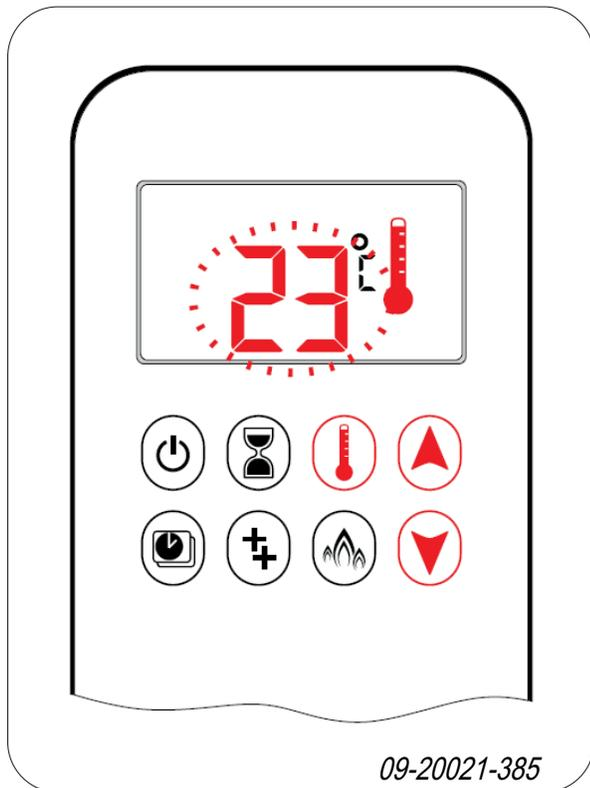
1. Halten Sie die Taste [**Thermostat**] gedrückt, bis die Temperatur blinkt.
