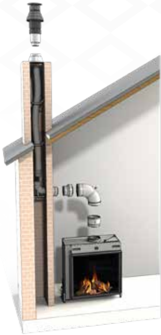
Via dak • flexibele pijp in schoorsteen
