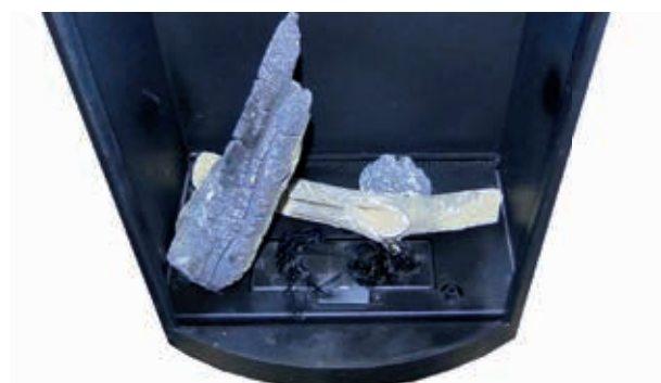
Montez la bûche 01 (L) sur le conduit de brûleur BP 1. Veillez à ce que la buse de la bûche glisse bien dans le conduit du brûleur.
