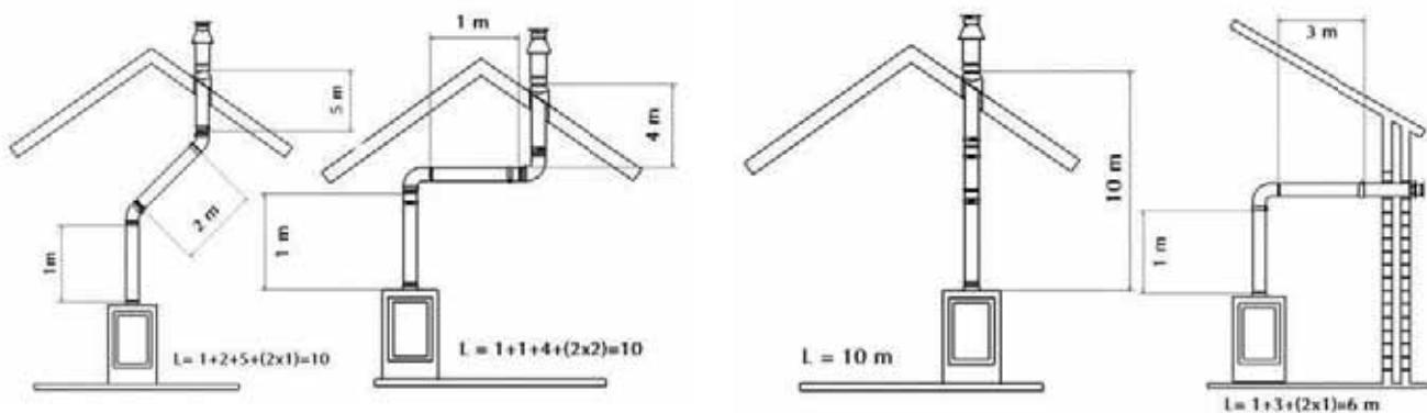
Machen Sie Ihre Wahl aus den Anschlussmöglichkeiten. Bauen Sie dann den ersten Meter konzentrisches Rohr auf das Gegenstück im Gerät. Wenn Sie von oben den blauen Dichtungsring im Rohr sehen können, wissen Sie dass die Montage korrekt ausgeführt ist. Ferner müssen Sie einen Abstand von minimal 5 cm zwischen der Außenseite des konzentrischen Rohrs und Wand oder Decke einhalten. Fangen Sie immer mit einem Meter senkrecht an.
