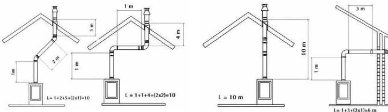
Faire votre choix du mode de placement. Construire alors le premier mètre de conduit concentrique à partir de la contre partie dans l'appareil. Vous saurez que le placement est correct si vous pouvez voir le dessus de l'anneau d'étanchéité bleu dans le tube. Maintenir une distance de 5 centimètres entre l'extérieur du système de conduits concentriques et la paroi ou le plafond. Toujours commencer avec 1 mètre vertical.
